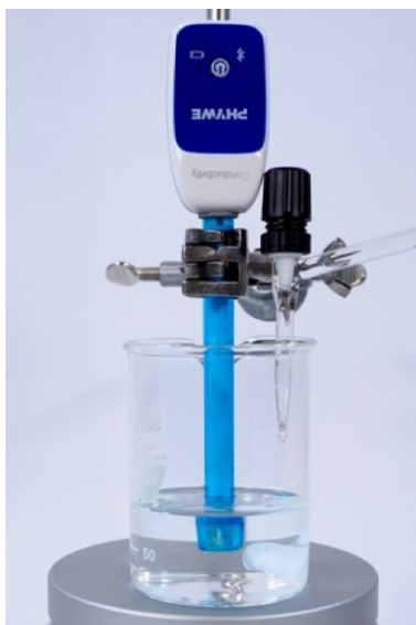
Abbildung 50. Potentiometrische Fällungstitration zur Bestimmung des Kochsalzgehaltes mithilfe des digitalen Messwertersystems Phywe® Cobra SMARTsense.
