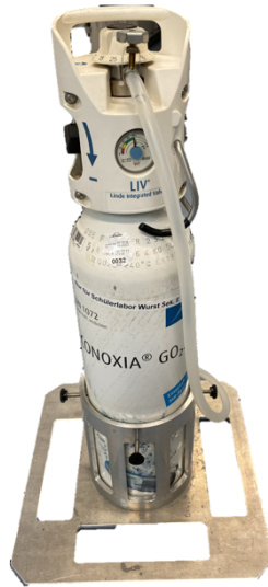
Abbildung 46: Druckgasflasche für medizinischen Sauerstoff der Firma Linde mit Leichtbaugestell der Feinmechanischen Werkstatt der Universität Osnabrück.
